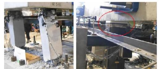
写真-1 通常柱の損傷状況(左)と自重補償柱がスラブを支持する様子(Case38)
