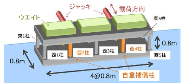
図-1 試験体概要図
