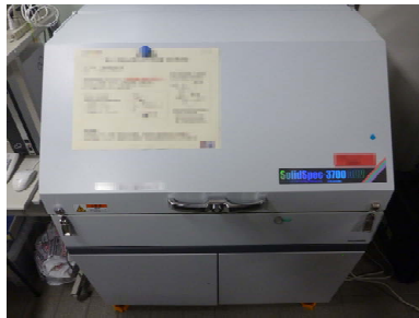
図2. 正透過率の測定原理（左）及び分光光度計外観（右）
