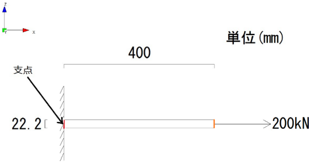
図 3 モデル載荷・拘束図
