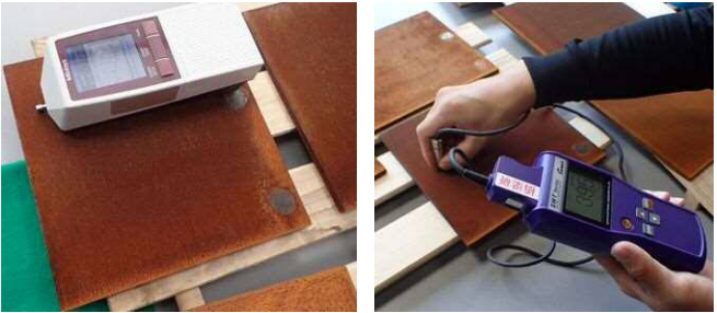
図-2 測定状況 (左: 表面粗さ, 右: 錆厚)
