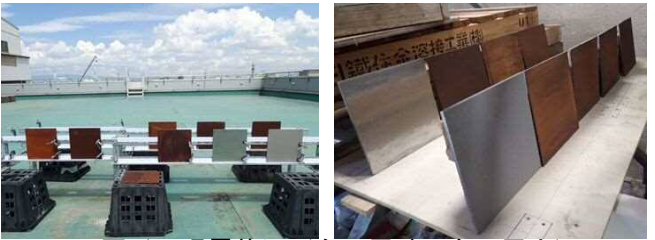
図-1 曝露状況 (左: 屋外, 右: 屋内)
