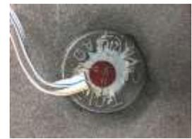
写真-4 ボルト頭部ひずみゲージ
