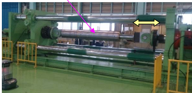
写真-1 セットアップ状況（水平一軸試験機）
