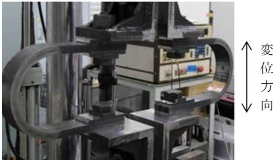
写真-1 疲労試験の実施状況 (R80b100t16e21tp8.3)
