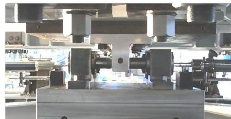
(b) 摩擦サイドブロック設置状況
