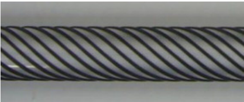
図-1 スパイラル突起付ケーブル模型 1.5x2.4mm x12 本 ( \gamma=27^\circ )
