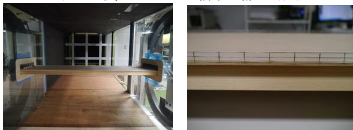
図 2. 模型および高欄の設置状況
