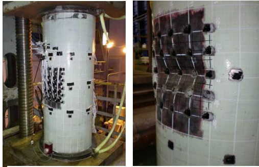
図－3 400mm 変形鋼管の圧縮試験
