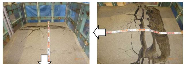
図 3 実験後の地表面状況 (矢印：管移動方向)
