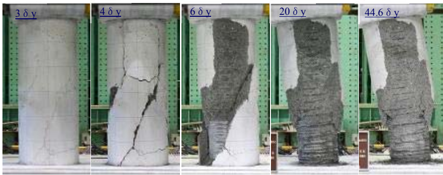
図2 試験体1の実験状況と荷重-変位関係
