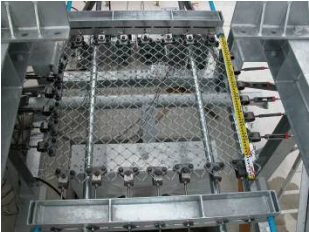
写真－1 面内静的試験
