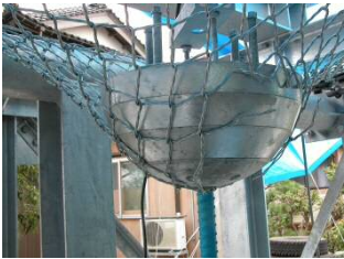
写真－2 面外静的試験
