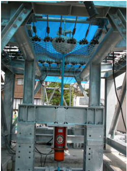
写真－2 面外静的試験
