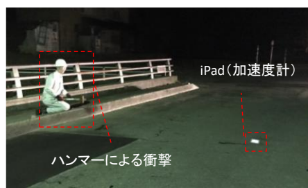
図-3 衝撃実験による加速度測定の様子
