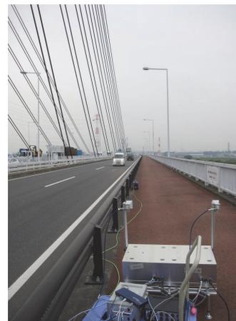
(a) 照明柱振動計測
