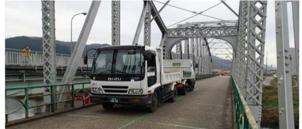
写真-1 実橋載荷試験
