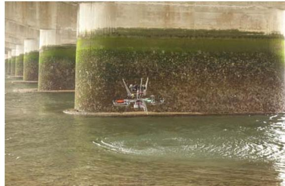
写真-3 ドローンによる桁下面の撮影状況
