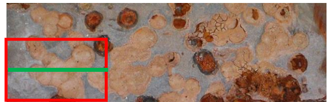
図3 腐食促進試験後の供試体
