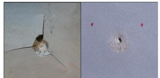
塗装系 S (5 回落錘時点)      新塗装系 (21 回落錘時点)
