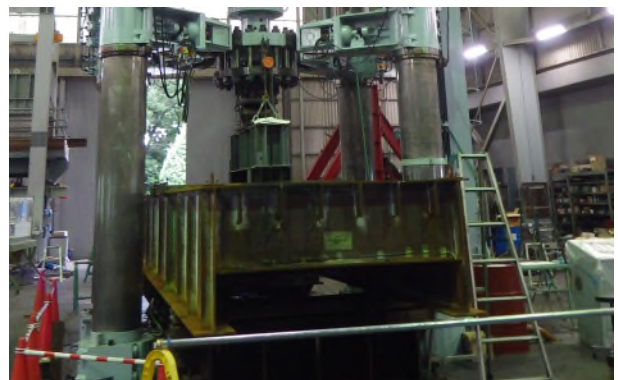
図3 定点荷重疲労試験の様子
