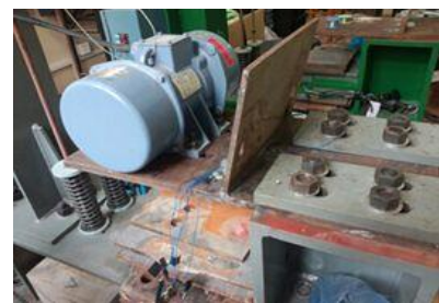
図-2 疲労試験中の様子
