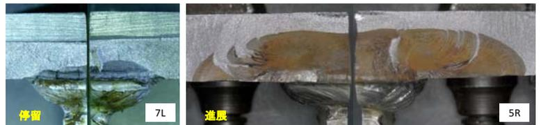
図 10 UIT により停留したき裂と進展したき裂の疲労破面
