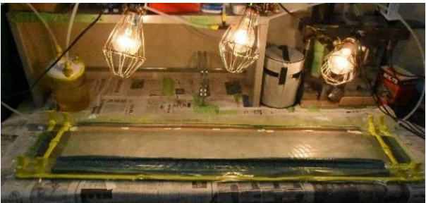
写真-1 VaRTM 工法による CFRP 接着の状況
