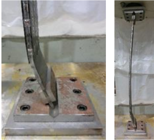
(a) CFRP 端部近傍の局部座屈 (b) 全体図 写真-3 10 層試験体の座屈後の変形
