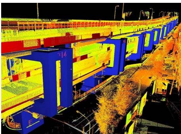
図-5 建設途中の3次元モデル
