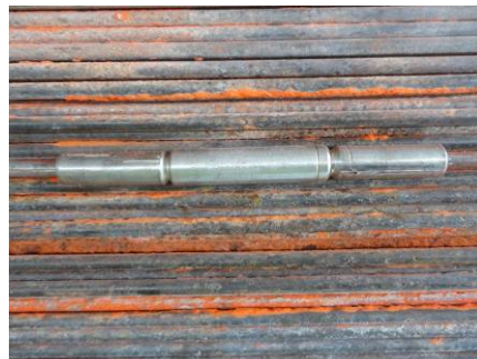
図 5 破断素線の再接合状況
