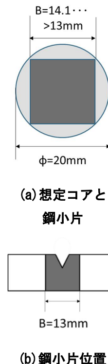
図-2 EBW による鋼小片
