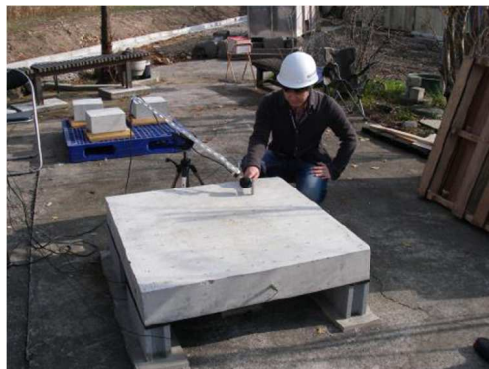
図2 コンクリート模擬供試体 (1m×1m×150mm)
