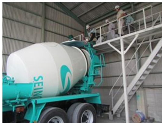
写真-2 繊維の投入試験状況
