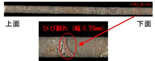
図-3 内部ひび割れの一部
