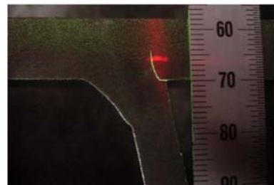
図-1 デッキ進展き裂 (模擬き裂試験片による)
