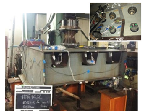
写真-1 荷重状況
