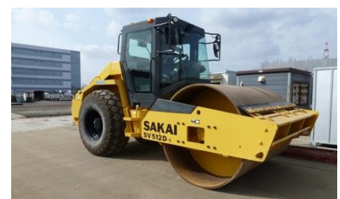
図-4 大型振動ローラによる転圧
