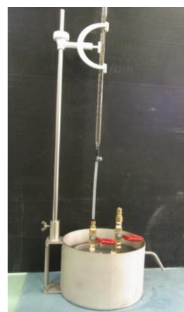
写真1 大気圧式小型変水位透水試験装置
