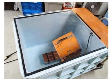
図-1 室内土砂飛散抑制試験
