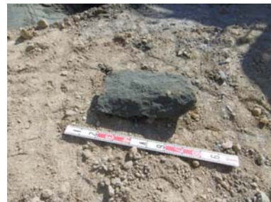
(a) 大年寺層の採取状況（黒色） (b) 大年寺層の採取状況（茶色） (c) スレーキング試験用サンプル
