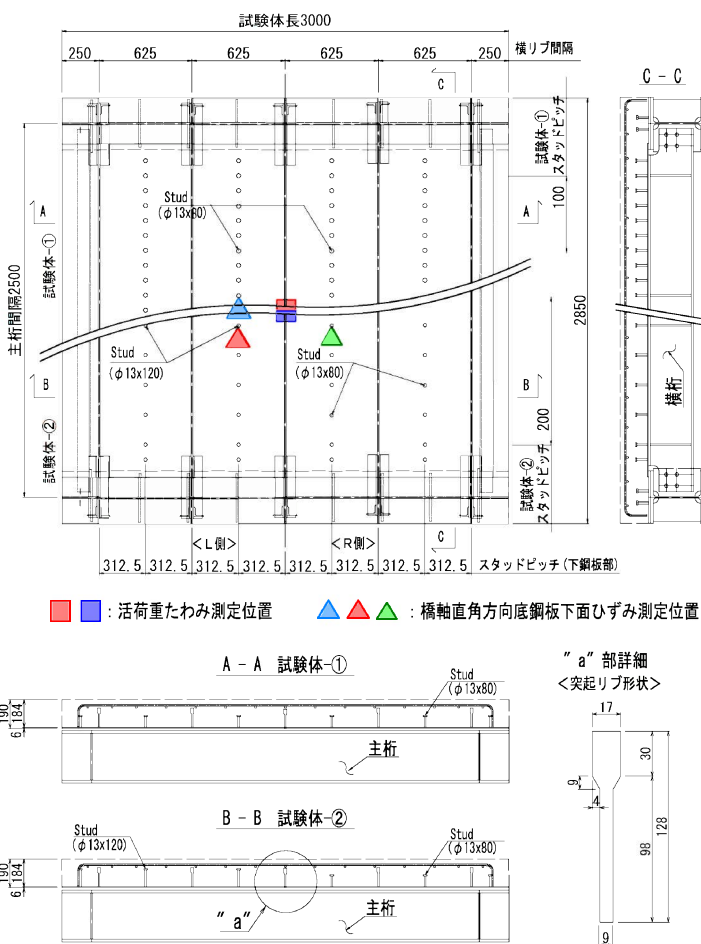
図-1 試験体詳細図および突起リブ形状
