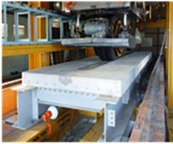
写真-1 輪荷重走行装置
