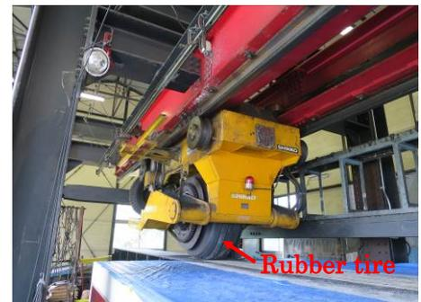
写真-2 輪荷重走行試験機
