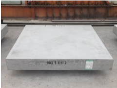
写真 3 健全および 舗装剥離用の外観
