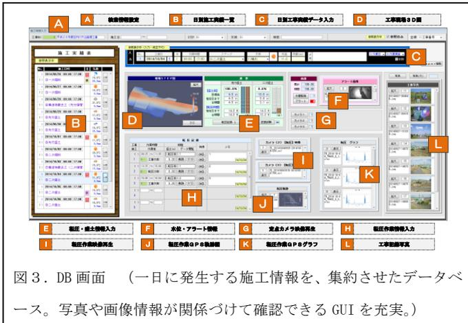
図3. DB画面（一日に発生する施工情報を、集約させたデータベース。写真や画像情報が関係づけて確認できるGUIを充実。）
