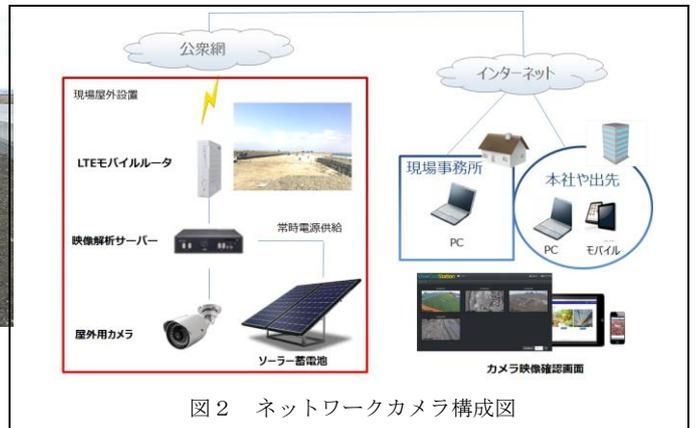
図2 ネットワークカメラ構成図
