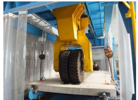
図1 輪荷重走行試験機
