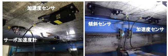
図2 加速度センサ外観
