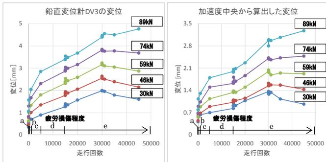
図6 静的載荷時の活荷重変位の比較
