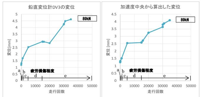
図7 動的載荷時の活荷重変位の比較
