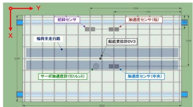
図3 床版へのセンサの配置（透視図）
