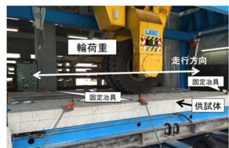
写真-1 輪荷重走行試験の状況
