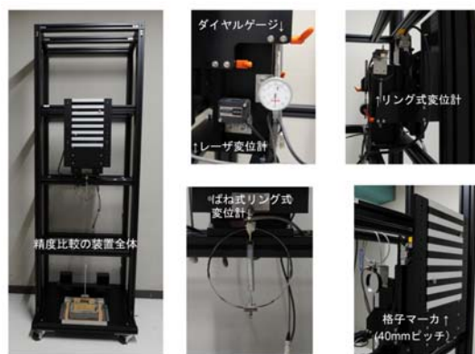
図-2 各種センサー取付け状況
