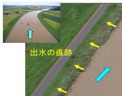
図5 俯瞰（斜め）写真による流況と洪水痕跡
