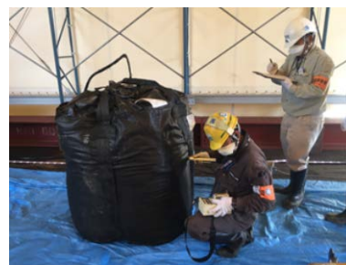
写真 1 フレコン表面の線量測定
