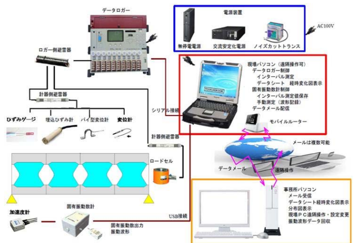
図 - 4 常時モニタリング計測システム
