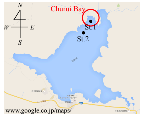
図-1 阿寒湖。St.1に波高計、St.2に風向・風速計を設置した。
