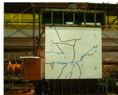
写真 2 ひび割れ状況
