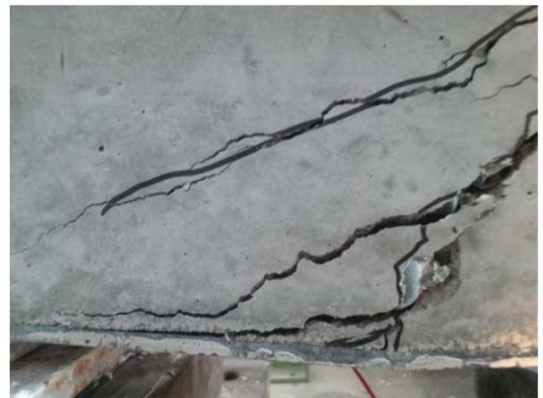
写真-1 鋼板の剥離（供試体 No. 4 の例）
